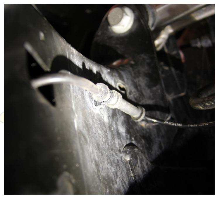
**RECONNECT:** FACTORY BRAKE WIRING LOOM
